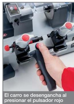
El carro se desengancha al presionar el pulsador rojo
