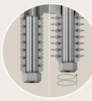
Anillos de expansión y arandelas cónicas de acero tratado. Expansion rings and treated steel conical washers.
