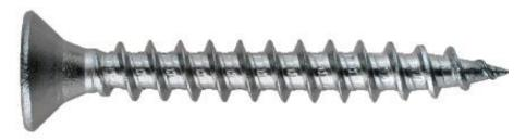
Denominación: CHIPBOARD SCREW DIN-7505-A, POZIDRIV, COUNTERSUNK 90º HEAD, THREAD 40º, POINT 25º, WAXED, ZINCPLATED
