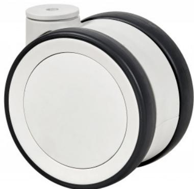
Rueda de poliuretano doble. Carcasa fabricada con fibra de vidrio reforzada. Soporte pivotante de fácil encaje. Cabezal giratorio con doble cojinete de bolas de precisión. Especialmente indicadas para soportar cargas hasta 125 Kg.
