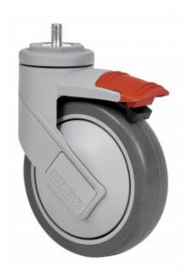
Rueda de goma termoplástica gris inyectada. Soporte fabricado en poliamida de alta calidad endurecida con fibra de vidrio. Cabezal giratorio superior construido en doble hilera de bolas endurecidas (fijación placa y agujero pasante) y cojinete de bolas de precisión insertado (fijación espiga roscada). Especialmente indicadas para soportar cargas hasta 100 Kg.
