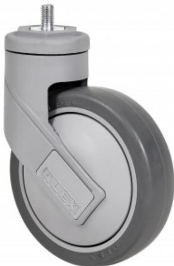
Rueda de goma termoplástica gris inyectada. Soporte fabricado en poliamida de alta calidad endurecida con fibra de vidrio. Cabezal giratorio superior construido en doble hilera de bolas endurecidas (fijación placa y agujero pasante) y cojinete de bolas de precisión insertado (fijación espiga roscada). Especialmente indicadas para soportar cargas hasta 100 Kg.
