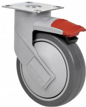
Rueda de goma termoplástica gris inyectada. Soporte fabricado en poliamida de alta calidad endurecida con fibra de vidrio. Cabezal giratorio superior construido en doble hilera de bolas endurecidas (fijación placa y agujero pasante) y cojinete de bolas de precisión insertado (fijación espiga roscada). Especialmente indicadas para soportar cargas hasta 100 Kg.
