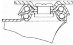
Fabricada con chapa de acero inoxidable (AISI 304) hasta 2 m/m de espesor. Soporte con doble rodamiento a bolas. Todos los componentes son de acero inoxidable. Resistente a la corrosión, grasas, aceites y gasolina. Fabricadas según normas europeas EN 12528/12530.
