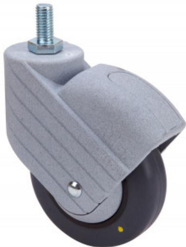
Ruedas conductiva con núcleo de polipropileno y banda de poliuretano gris. Especialmente indicadas para soportar cargas hasta 40 Kg. Nuestra gama de ruedas de la serie HP-PGC está recomendada para los sectores de media capacidad de carga. Su uso es aplicable en: expositores, muebles, taburetes, restauración, hospitales, útiles, portagoteros, mobiliario clínico sanitario, goteros, carros de limpieza, quirófanos.
