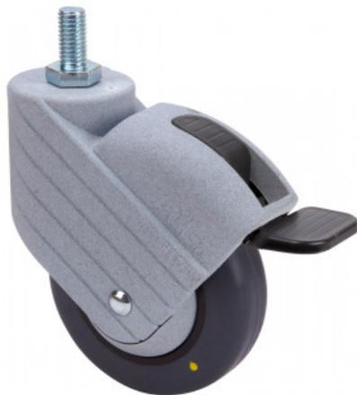
Ruedas conductiva con núcleo de polipropileno y banda de poliuretano gris. Especialmente indicadas para soportar cargas hasta 40 Kg. Nuestra gama de ruedas de la serie HP-PGC está recomendada para los sectores de media capacidad de carga. Su uso es aplicable en: expositores, muebles, taburetes, restauración, hospitales, útiles, portagoteros, mobiliario clínico sanitario, goteros, carros de limpieza, quirófanos.
