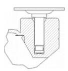
Fabricada en poliamix reforzado Aros: núcleo de poliamix y banda de goma o material especial conductivo Freno ergonómico redondeado con retorno integrado Soporte con espiga lisa o roscada, con y sin freno Color personalizado opcional.
