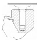
Soporte de poliamida para albergar las dos ruedas gemelas. Fijaciones: platina,espiga roscada, espiga con anilla, espiga lisa, fijación para cantos. Cubierta: Negro, gris, latonado,cromado. Aro: Bandaje en polipropileno negro o gris, poliuretano gris.
