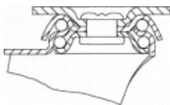
Soporte de chapa de acero. Acabado cromado. Tipo de fijación: Pletina giratoria o agujero pasante. Disponible con freno doble (palanca gris). Aro policarbonato Color de los aros: simil cristal.
