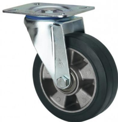
Ruedas de núcleo de aluminio con banda de goma negra elástica con una dureza 70° shore A. Especialmente indicada para soportar cargas hasta 400 Kg.
