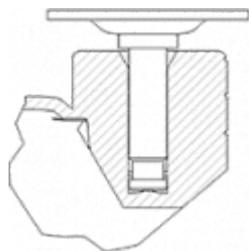
Soporte con placa y espiga roscada, con y sin freno. Freno ergonómico redondeado con retorno integrado. Fabricadas en poliamix negro reforzado. Diseñadas especialmente para el sector mobiliario y restauración. Color personalizado opcional. Fabricadas según normas europeas EN 12528.
